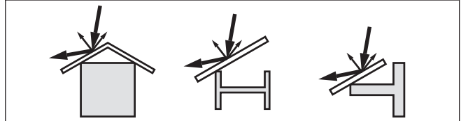
Fig. 9: Recouvrir les obstacles lisses par des déflecteurs
