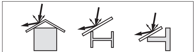
Fig. 14: Recouvrir les obstacles lisses par des déflecteurs
