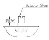
Fig. 3-15: Actuator stem Height
