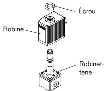
La bobine et la robinetterie peuvent être commandées au complet sous le numéro d'identification d'appareil.
