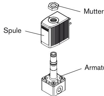
Spule und Armatur können komplett unter der Identnummer des Gerätes bestellt werden.
