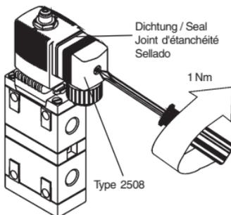
Montage / Assembly / Montage / Montaje
